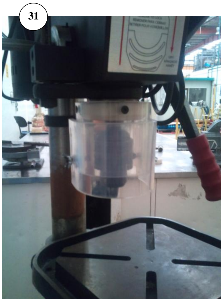
Fig. 12 Guarda de Seguridad en taladro vertical
