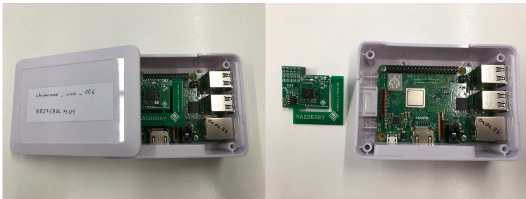
Ilustración 11: Gateway que permite conectar los sensores Z-Wave y módulo de comunicación
