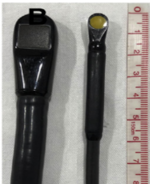
Figura 19. Comparativa de una sonda de ecocardiografía transesofágica convencional (izquierda) y una sonda miniaturizada (derecha).
