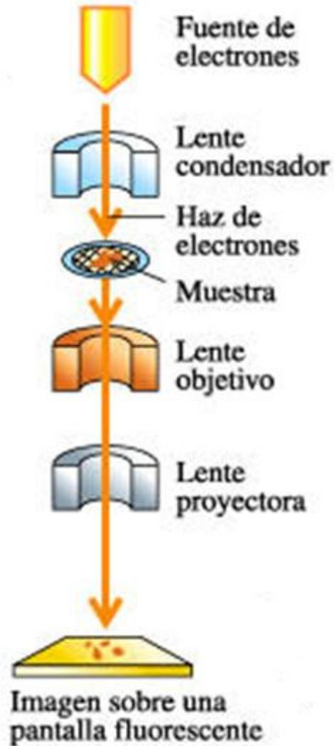
Figura 2. Esquema de funcionamiento de TEM
