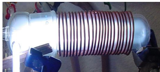
Figura 1.4. Plasma de aire por descarga inductiva luminiscente.
