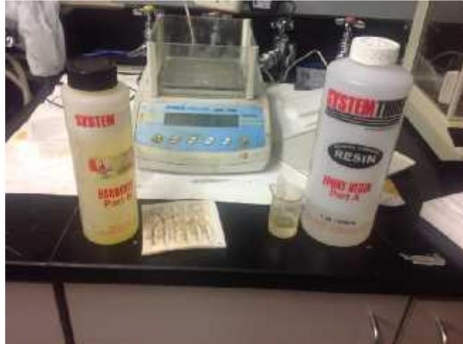
**Figura 12.** Resina epóxica utilizada para sujetar las fibras
