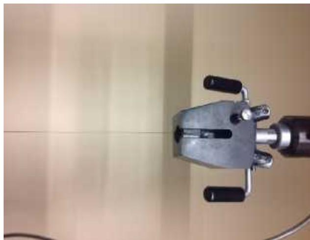
**Figura 13.** Hilo de seda con nanopartículas de Plata sujetado en prensa
