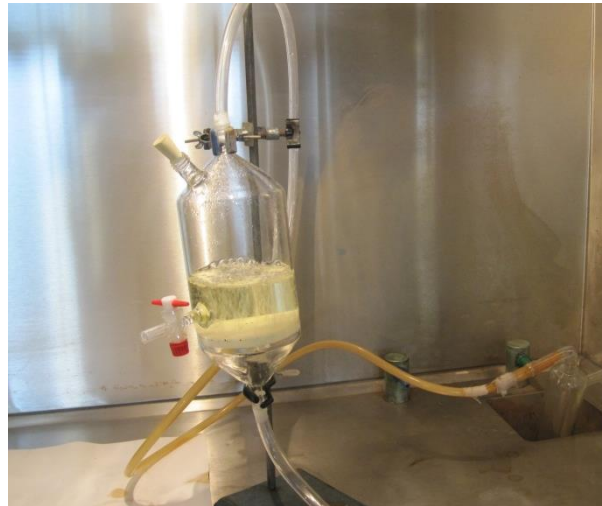
Figura 4.2 Montaje de la columna de burbujeo de flujo ascendente
