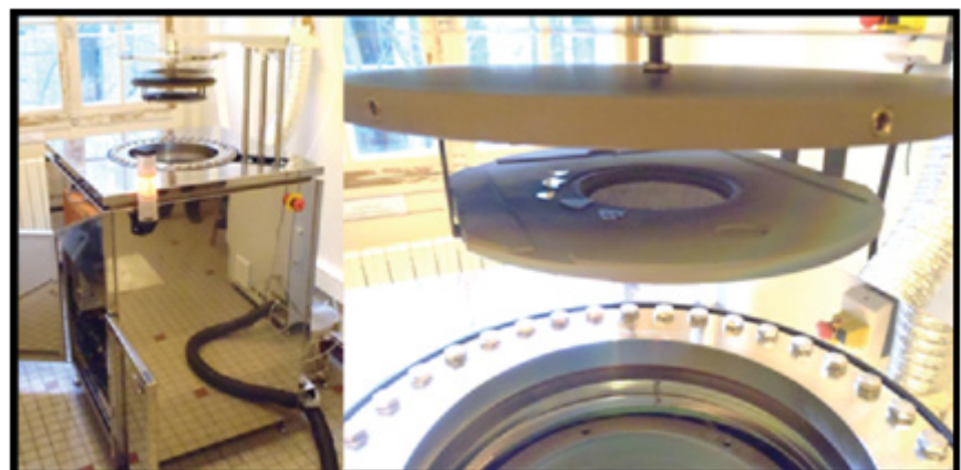
Figura 14. Máquina de ALD de flujo vertical propiedad de la ENSCP, París, Francia.
