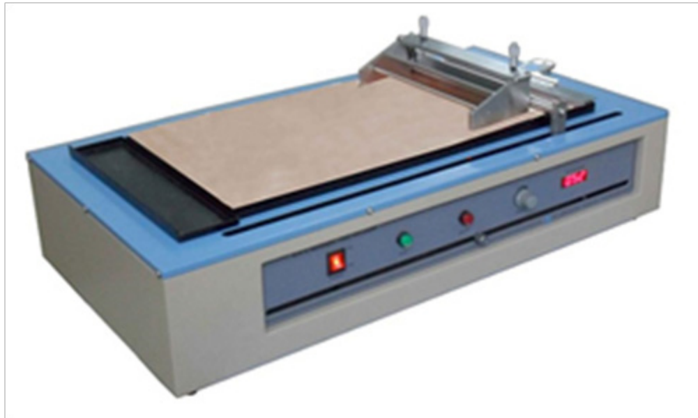
Figura 8. Imagen de una máquina de tape-cast de laboratorio, la placa que crea la película es la que está en movimiento.
