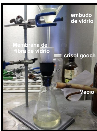
Figura 9. Proceso de filtración de la muestra de agua residual
