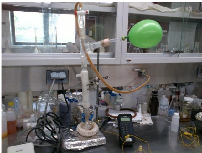
**Fig. 24.** Sistema montado para la síntesis de nanopartículas magnéticas funcionalizadas con PEGCOOH 6000
