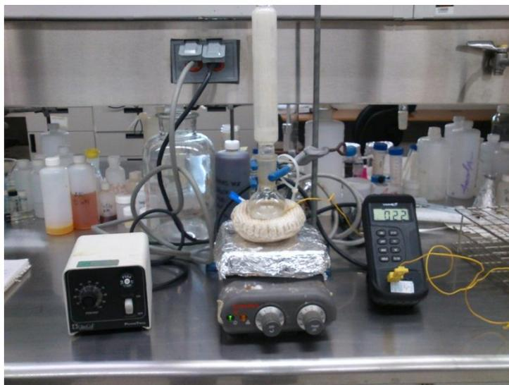
**Fig. 19.** Sistema utilizado en la síntesis de MNP's funcionalizadas con TREG
