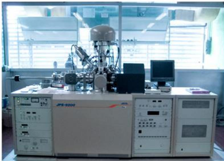
Figura 1.2.4. Espectroscopio fotoelectrónico de rayos X .
