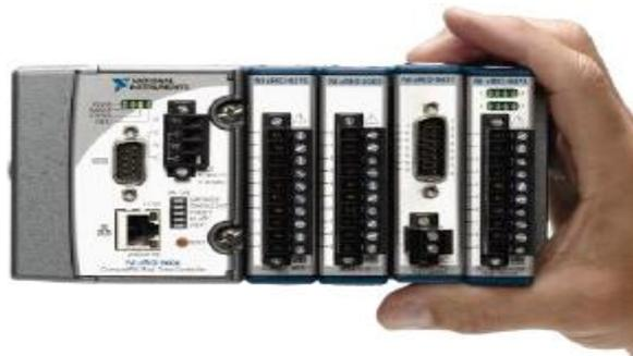
**Figure (IV.8)** CompactRIO avec son contrôleur et ses modules
