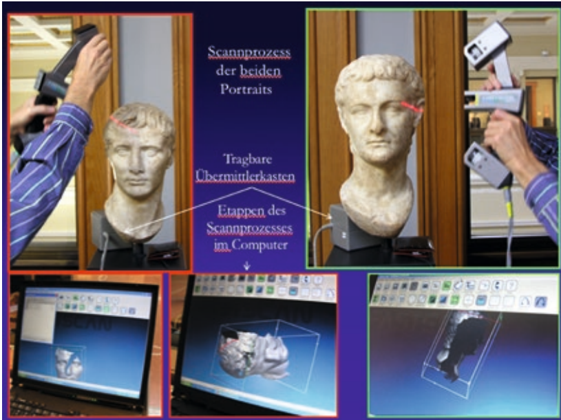
13a Scanvorgang des ›Getty-Augustus‹ und des ›Getty-Caligula‹ und ihre 3D-Modelle auf einem Laptop-Bildschirm
