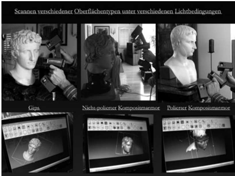
10 Scanvorgang dreier Kopien antiker Porträts (Sammlung J. Pollini) und ihre 3D-Modelle auf einem Laptop-Bildschirm (siehe Taf. 12c)
