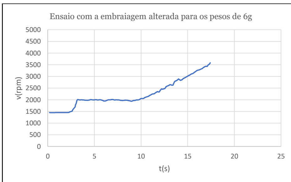
Figura 31 - Quinto ensaio do motor realizado com a embraiagem alterada com os pesos de 6 g.
