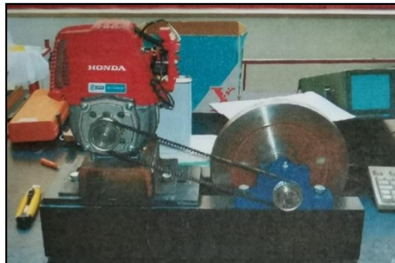
Figura 17– Motor GX31 acoplado ao dinamómetro, preparação do ensaio [12].
