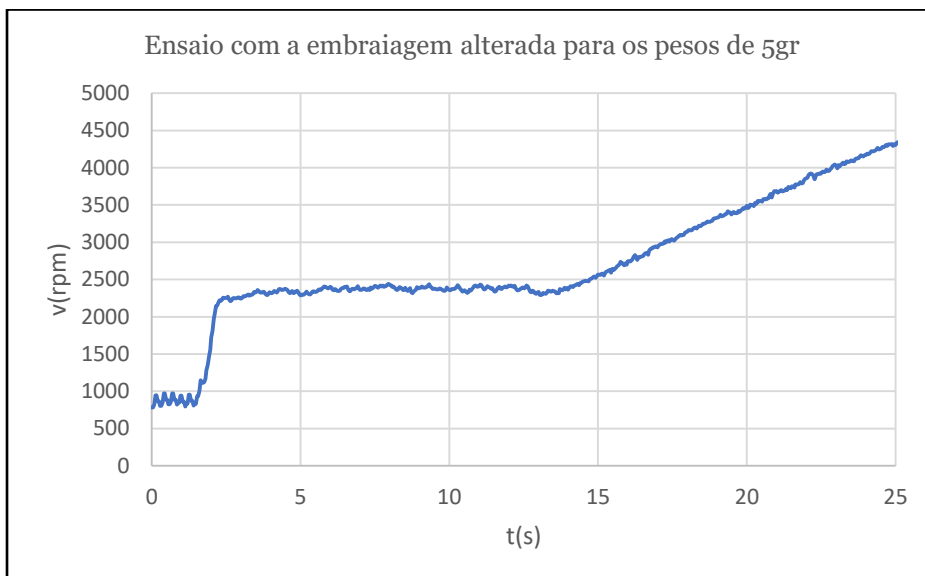
Figura 29 - Terceiro ensaio do motor realizado com a embraiagem alterada com os pesos de 5g.
