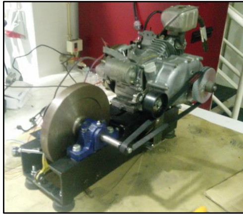
Figura 23 – Motor Honda GX 160 montado no dinamómetro com o respetivo sistema de transmissão.
