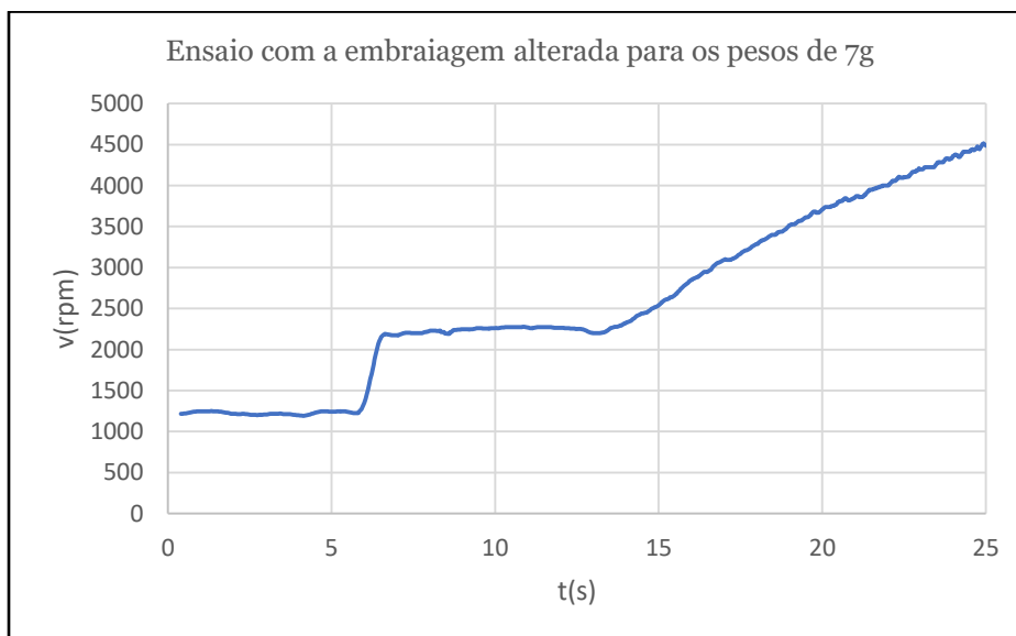
Figura 33 - Sexto ensaio do motor realizado com a embraiagem alterada com os pesos de 7 g.
