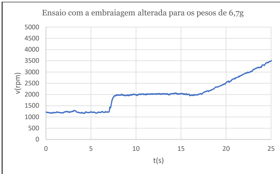
Figura 36 - Oitavo ensaio do motor realizado com a embraiagem alterada com os pesos de 6,7g.
