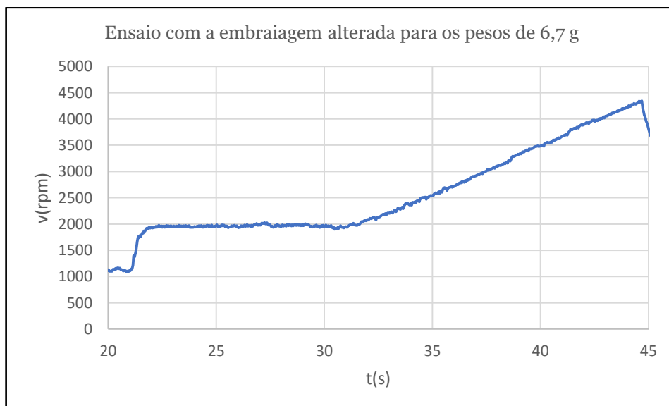
Figura 35 - Sétimo ensaio do motor realizado com a embraiagem alterada com os pesos de 6,7g.
