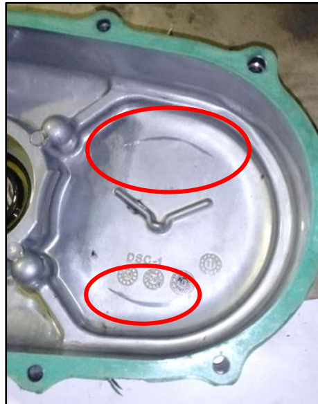
Figura 32 - Marca feita na tampa da caixa da embraiagem provocada pelos pesos de 6 g.
