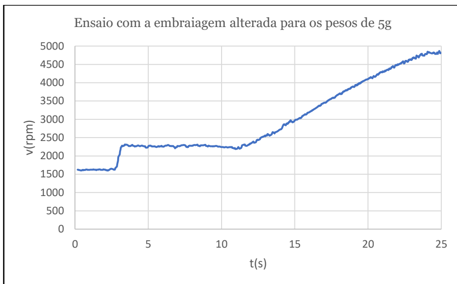
Figura 30 - Quarto ensaio do motor realizado com a embraiagem alterada com os pesos de 5 g.
