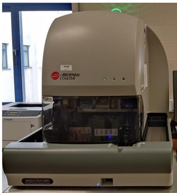
Figura 17: Analisador hematológico DxH 600 (Beckman Coulter) utilizado no laboratório de hematologia do CHTV.
