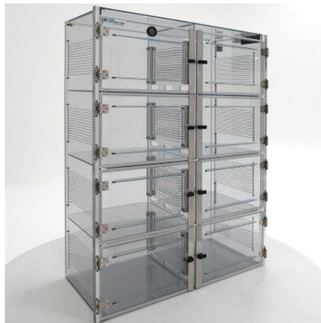
Figura 16 - Dessecador de armazenamento de biopolímero, retirado de [65].
