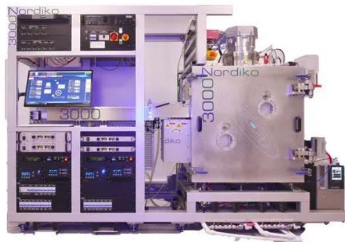
Figura 17 - Nordiko 3000, equipamento para a deposição de Crómio e Ouro por feixe de iões, retirado de [70].
