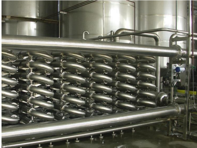
Figura 12 - Sistema de membranas de diálise para o isolamento do biopolímero, retirado de [59].
