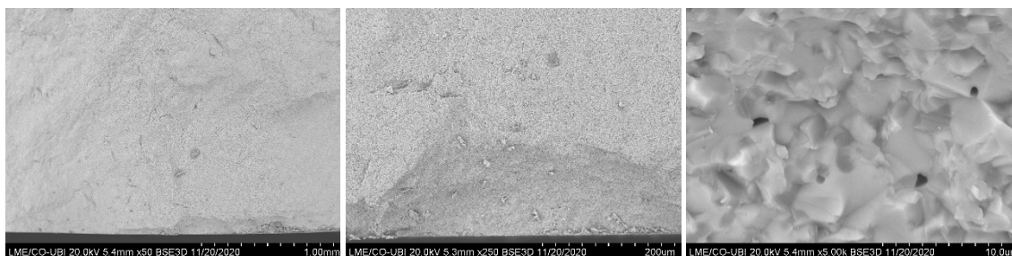
FIGURA 25: SUPERFÍCIE DE FRATURA TÍPICA DO MATERIAL 1 (CZM): A) IMAGEM COM AMPLIAÇÃO REDUZIDA; B) IMAGEM COM AMPLIAÇÃO ELEVADA.
