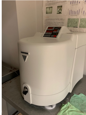
FIGURA 12: MOINHO DE ALTA ENERGIA FRITSCH, PULVERISETTE 6 , ALEMANHA.
