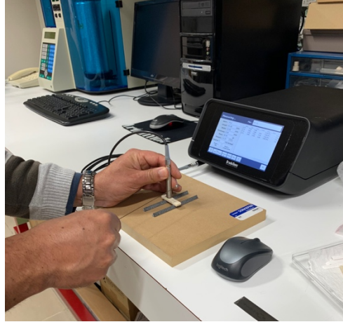
FIGURA 17: ILUSTRAÇÃO DO ENSAIO DE DETERMINAÇÃO DO MÓDULO ELÁSTICO USANDO O EQUIPAMENTO GRINDOSONIC MK7 .
