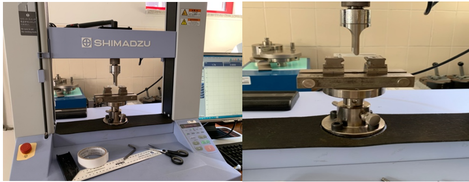
FIGURA 19: VISTA GERAL DA MÁQUINA DE ENSAIO, SHIMADZU AGX . MESA DE FLEXÃO EM TRÊS PONTOS COM ILUSTRAÇÃO DE UM ENSAIO NUMA BARRA CERÂMICA.
