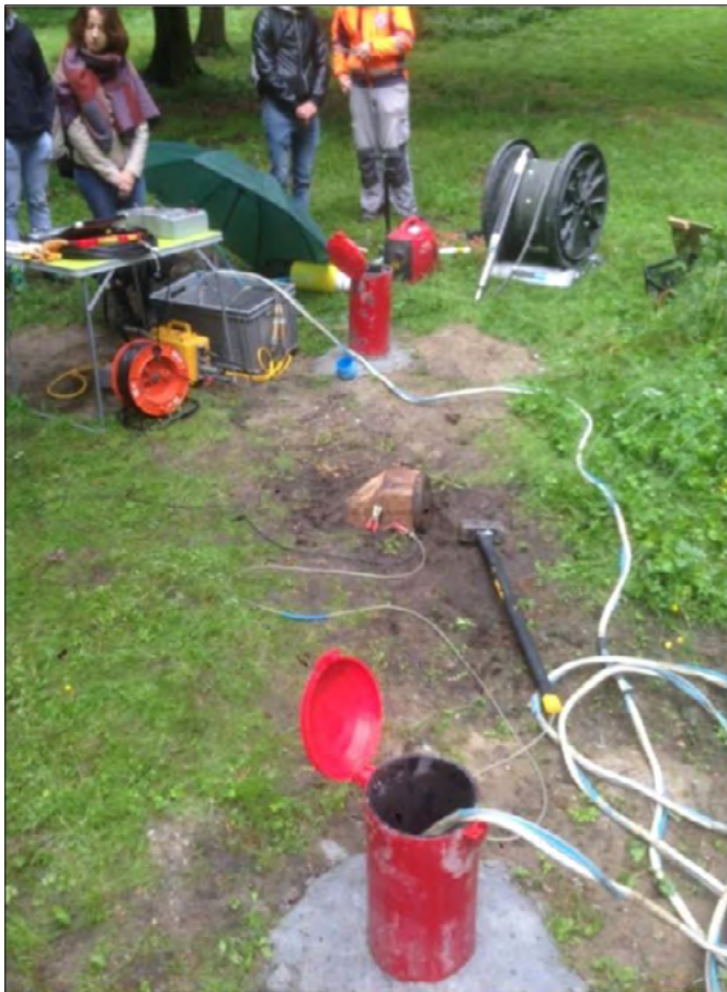
FIGURA 7 - Prova Downhole DH2. In primo piano si può notare il foro di sondaggio S2, allestito per l'esecuzione della prova, mentre in secondo piano il foro di sondaggio S1. All'interno dell'S2 è situato il sistema ricevente collegato in superficie al sistema di acquisizione; a metà fra S2 e S1 è situato il sistema energizzante costituito da una mazza sismica, collegata al trigger, e da una zavorra metallica su cui si eseguiranno le energizzazioni.
