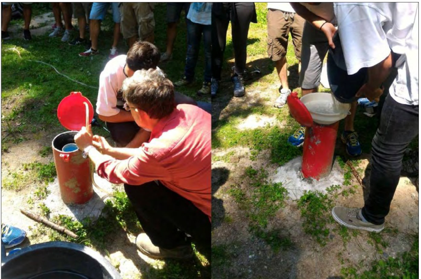
FIGURA 6 - Prove di tracciamento nell'acquifero con NaCl. A sinistra, tubazione utilizzata per l'iniezione; a destra, immissione di soluzione salina a caduta all'interno dell'imbuto.
