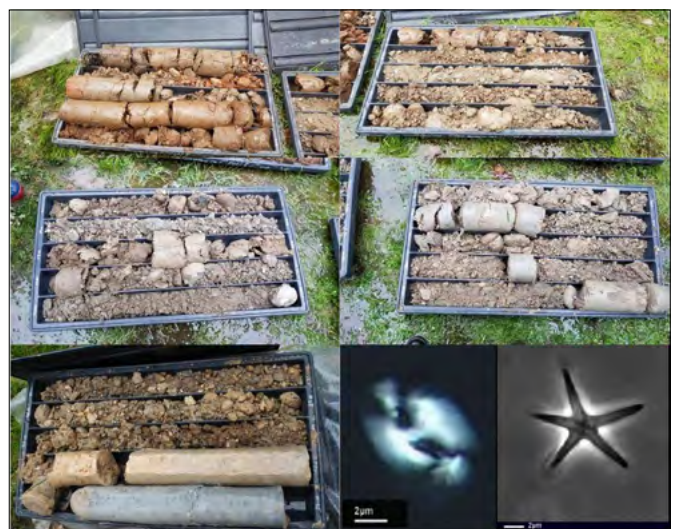
FIGURA 4 – Nella sequenza fotografica, i 25 m di carotaggio: a circa 23 metri di profondità si incontra del terreno impermeabile (argille nocciola e marne grigio azzurre in basso a sx) su cui vengono intestati i due piezometri. Dalle analisi micropaleontologiche effettuate dalla prof.ssa Francesca Lozar, le marne grigio azzurre vengono attribuite al Pliocene per la presenza di particolari microfossili (in basso a sinistra).
