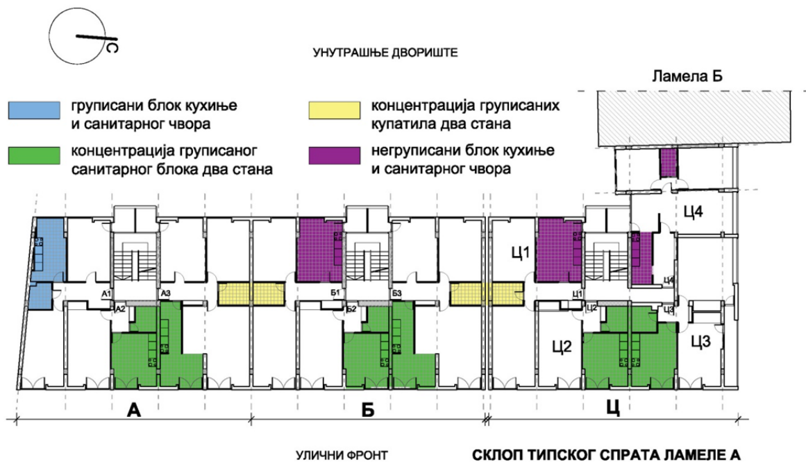
Слика 76. Диспозиција инсталационих блокова у становима типског спрата ламеле А Извор: аутор на основу оригиналне документације из Историјског архива из Ниша
