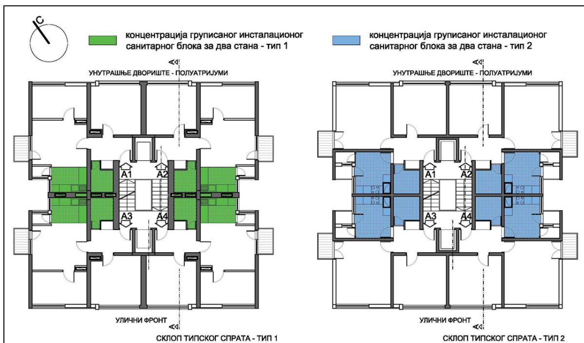
Слика 112. Диспозиција инсталационих блокова у становима типског спрата Извор: аутор на основу оригиналне документације из Историјског архива из Ниша
