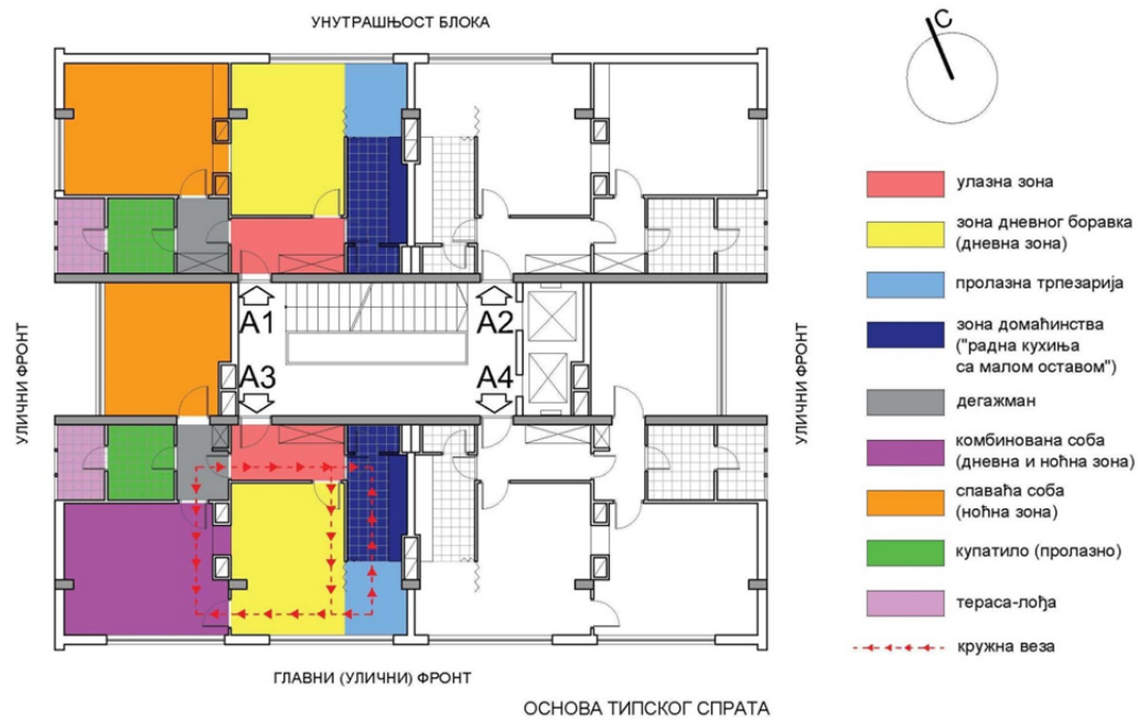
Слика 63. Функционална организација станова типског спрата стамбене куле Извор: аутор на основу оригиналне документације из Историјског архива из Ниша
