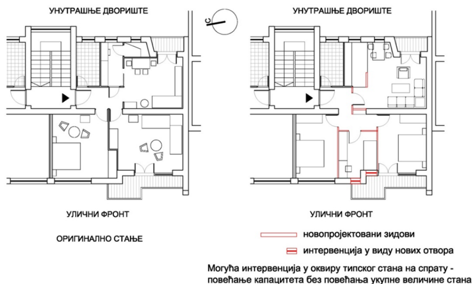
Слика 42. Варијанта флексибилног коришћења простора на примеру карактеристичног стана Извор: аутор на основу оригиналне документације из Историјског архива из Ниша
