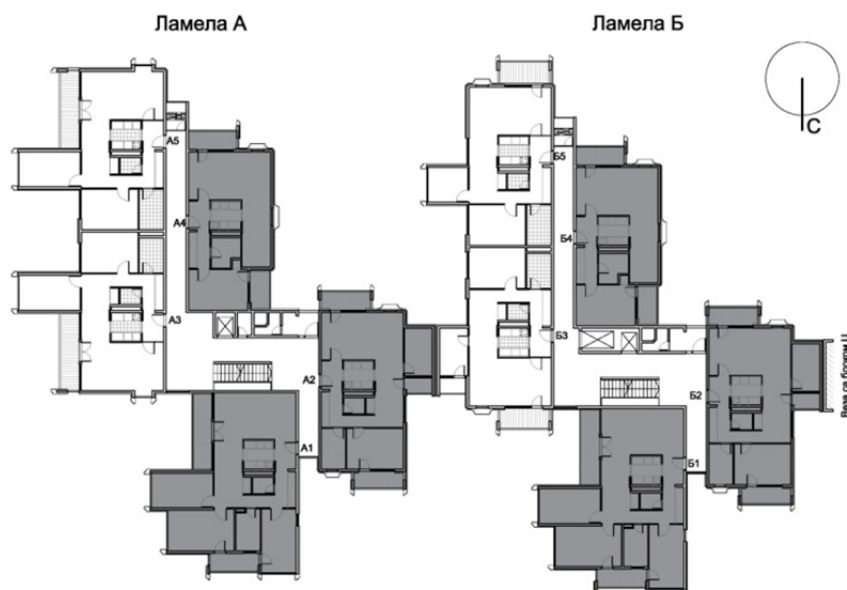
Слика 205. Структура и функционална организација станова у оквиру ламела А и Б Извор: аутор на основу оригиналне документације из Историјског архива из Ниша
