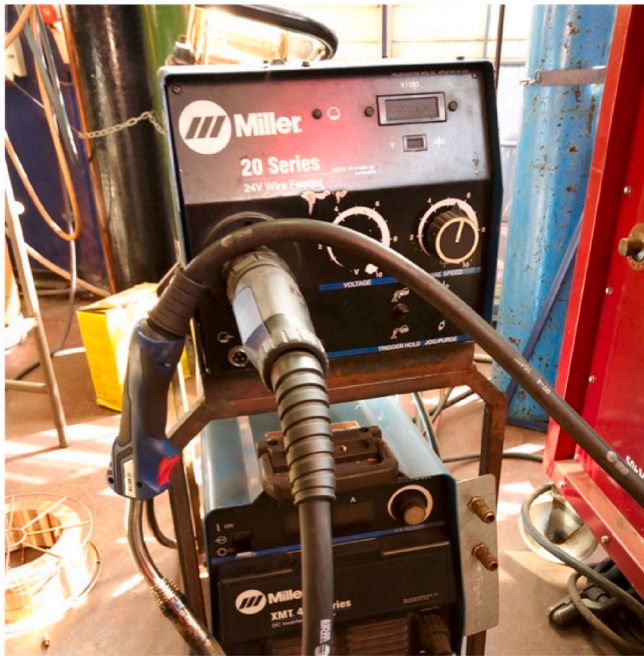
Fig. 1. MIG welding machine.
