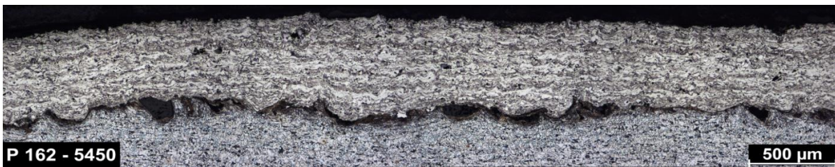
Obr. 3 Makrostrukturální pohled na nástřik a jeho rozhraní
