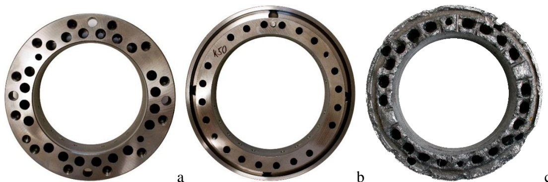
Obr. 1: Vzhled chladícího kroužku (a, b – nepoškozeného, c – poškozeného)
