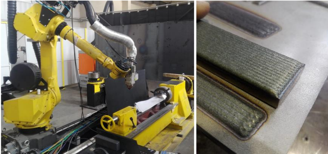
Obr. 1: Ustavení pracoviště, příklad z průběhu ladění housenek návaru
