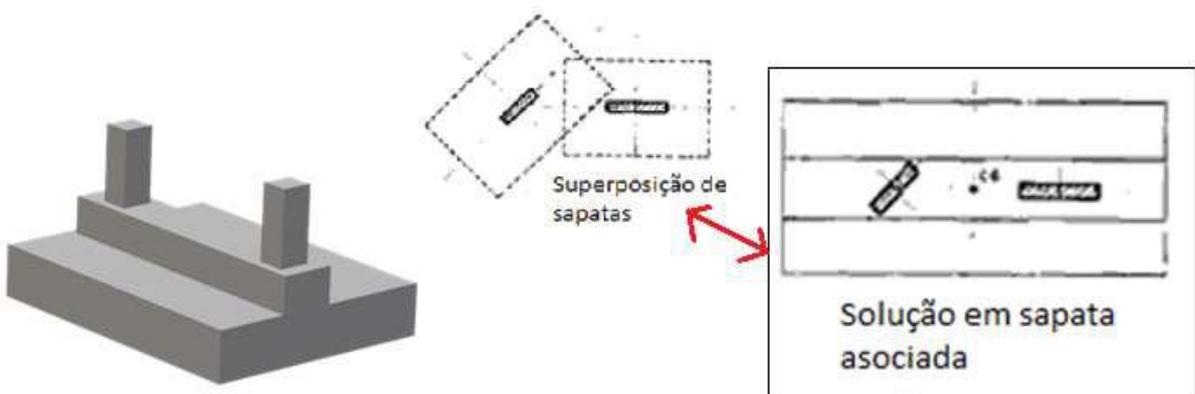
Figura 3.4- Sapatas associadas. Fonte: <https://celere-ce.com.br/construcao-civil/fundacoes-de-obras/>.
