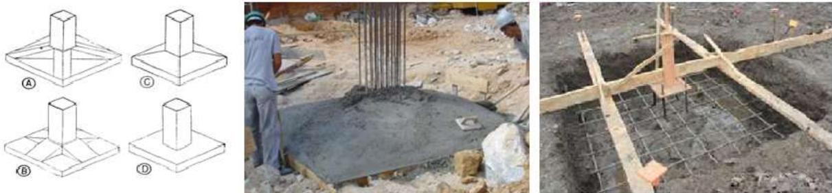
Figura 3.2- Sapatas isoladas. Fonte: Fundações Melhado; Silvio 2002 e Guimarães,(2021).
