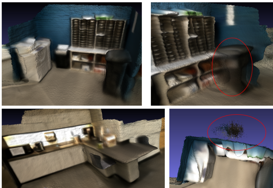
Рисунок 3.13 – Приклад синтезованих BARF карт глибин у вигляді 3D сітки з застосуванням функції втрат для оптимізації карт глибин
