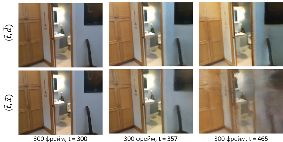
Рисунок 3.24 – Синтезовані зображення, які моделюють різне освітлення датасету scene0000_00. Верхній рядок відповідає моделі BARF, де змінна часу подається разом з напрямками променів (\vec{t}, \vec{d}) , а нижній - моделі BARF, де змінна часу подається разом з 3D координатами (\vec{t}, \vec{x})
