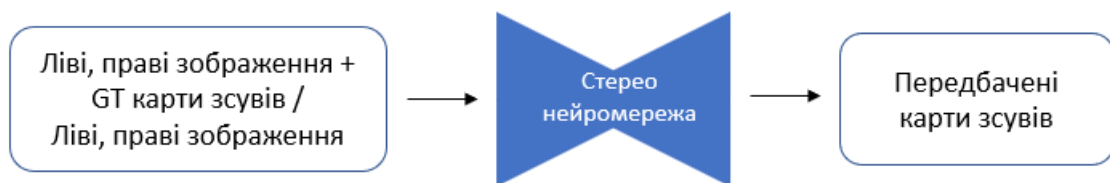
Рисунок 2.1 – Стандартний ланцюжок навчання стереонеймереж для оцінки карт глибин (тренування з учителем / тренування без учителя)
