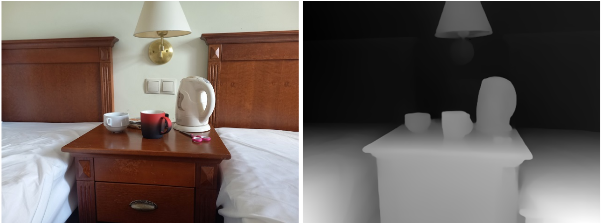
Рисунок 3.5 – Приклад оригінального лівого зображення та передбаченої карти зсувів за допомогою Midas моделі
