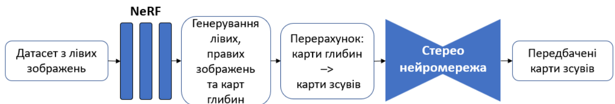
Рисунок 2.2 – Пропонований ланцюжок навчання стереонеймереж для оцінки карт глибин
