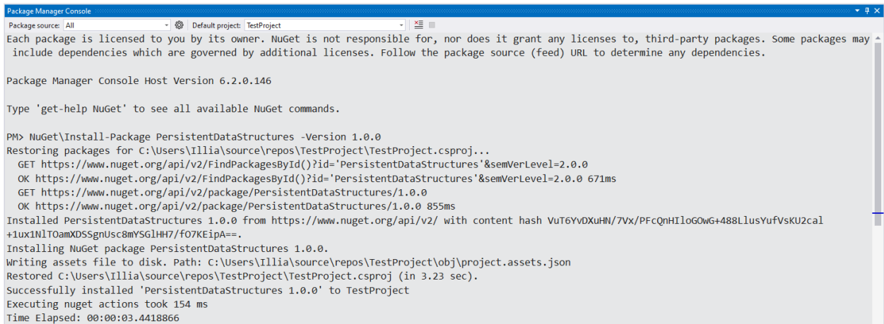
Рисунок 4.3 – Встановлення бібліотеки за допомогою консолі пакетного менеджера NuGet
