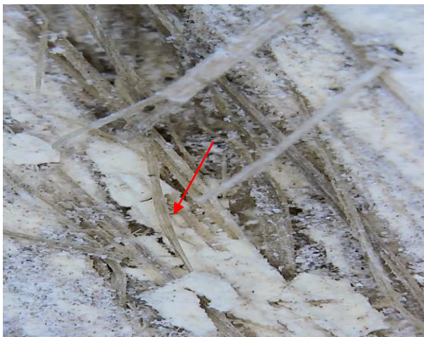
(صورة ١٣-ب) توضح تكسير وتلف الجبس نتيجة للحرارة. باستخدام Wireless USB Microscope X1000
