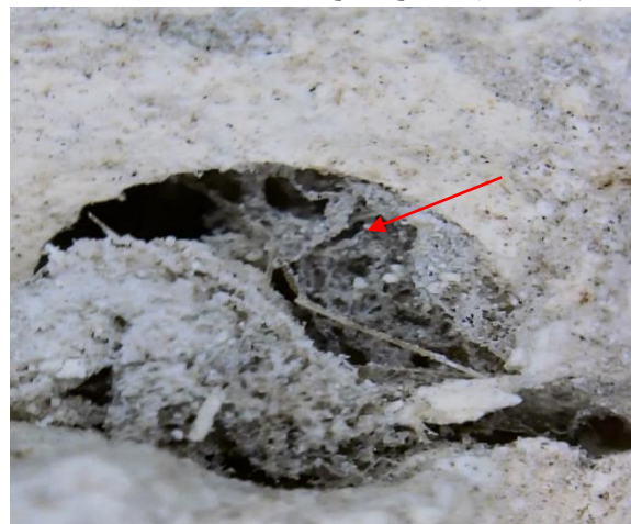
(صورة ١٣-أ) توضح تداخل فضلات الطيور داخل الزخارف باستخدام Wireless USB Microscope X800
