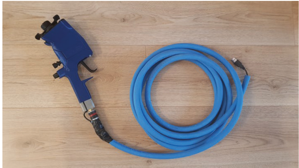
Abb. 2: 3D-Druck einer nachgebauten Lackierpistole mit Druckschlauch.
