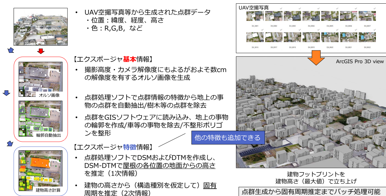
図1. UAV を用いて撮影された写真群を用いて市街地の高密度点群データを作成し、建物の高さや平面形状などの建物の特徴を判別する技術を構築
