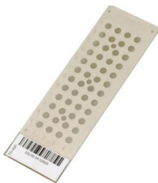
Figura 6.2. Portaobjetos de acero inoxidable (FLEXI MASS ™ , bioMérieux). El pocillo central sirve para inocular el control o calibrador y el código de barras para tener un registro e identificación de la placa.
