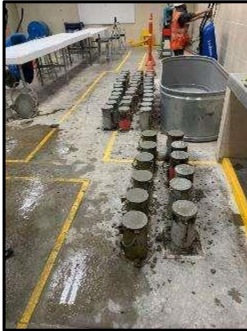
Ilustración 51: Probetas De Concreto (Testigos Cilindricos).
