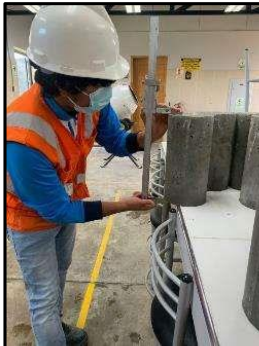
Ilustración 54: Medición De Las Probetas De Concreto (Testigos Cilindricos).
