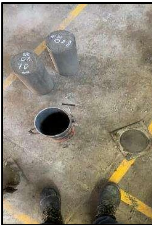
Ilustración 52: Desencofrado De Las Probetas De Concreto (Testigos Cilindricos).
