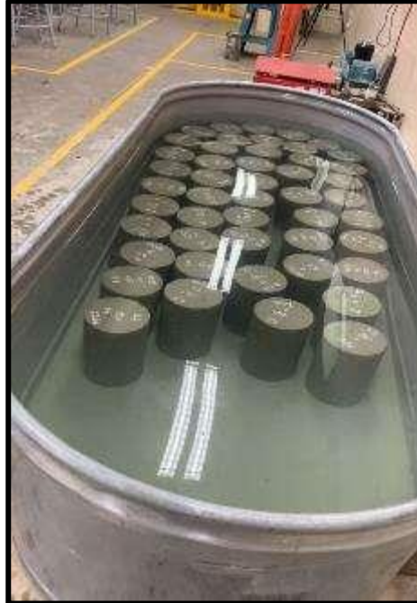
Ilustración 53: Curado De Las Probetas De Concreto (Testigos Cilindricos).
