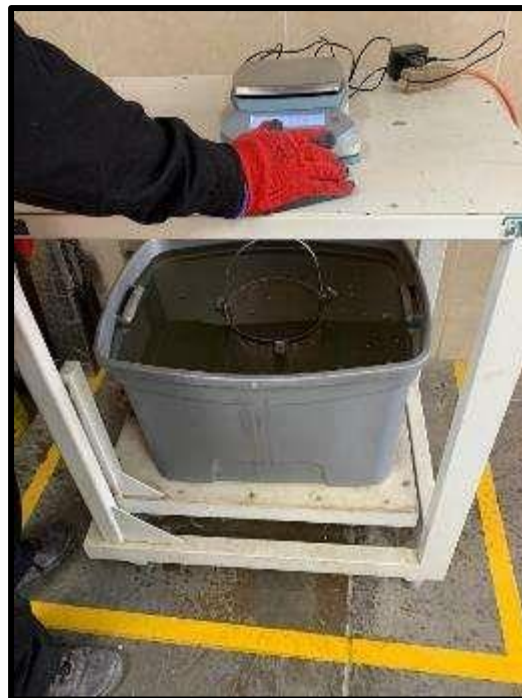
Ilustración 25: Equipo Para Ensayo De Peso Especifico Y Absorcion Del Agregado Grueso.
