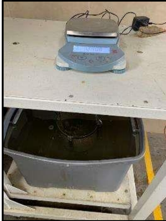
Ilustración 27: Peso De La Muestra En La Canastilla Sumergida En Agua (Agregado Grueso).
