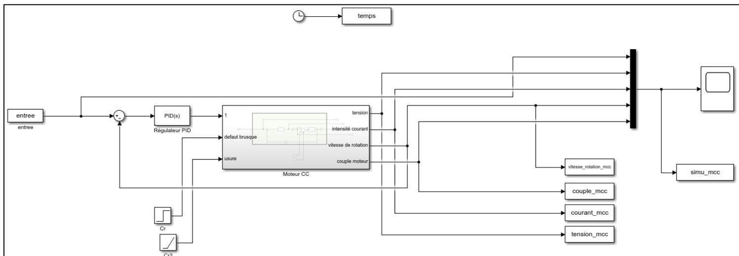
Figure 3 - Modèle SIMULINK du moteur électrique
