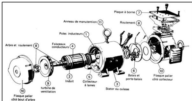
Figure 1 - Schéma d'un moteur à courant continu [8]
