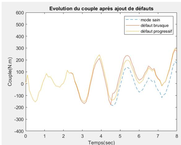
Figure 4 - Couple du moteur en mode sain et défaillant
