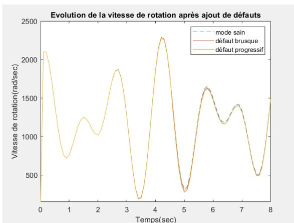
Figure 6 - Vitesse du moteur en mode sain et défaillant
