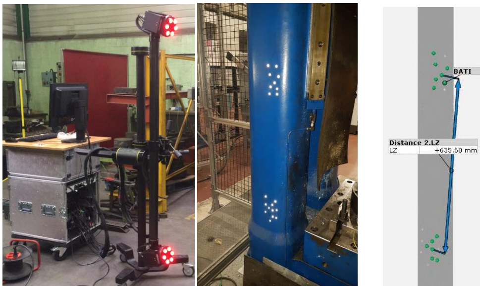
Figure 11 : Installation du Pontos et des gommettes sur un des tirants de la presse et affichage du Pontos représentant la distance initiale entre les gommettes sélectionnées
