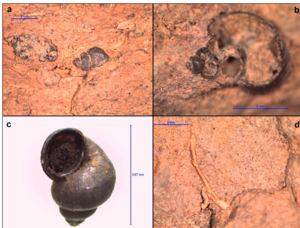
Figura 8.8. Muestra V1179. Imágenes de lupa digital mostrando diferentes caparazones de gasterópodos de agua dulce de la familia Melanopsidae a) 10X, b) 20X, c) 20X, d) raíces naciendo del interior de la muestra (12,5X).
