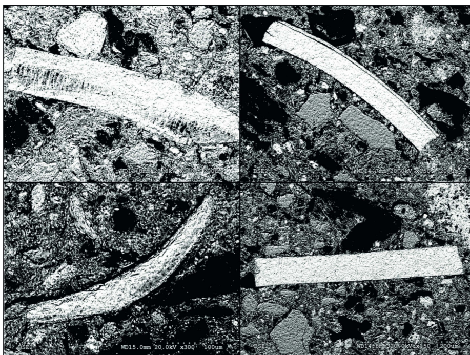
Figura 8.31. Muestra V168-J. Imágenes de SEM mostrando fragmentos de conchas de gasterópodos: a) 150X; b) 200X; c) 300X; d) 150X.
