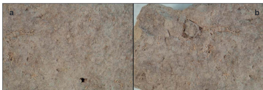
Figura 8.6. Muestra V168-J. Imágenes de las caras más anchas de la pesa de telar mostrando su uniformidad y las pequeñas raíces que corren por su superficie..
