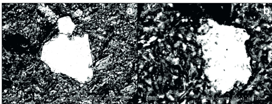
Figura 8.32. Muestra V168-J. Imágenes de SEM: a) ilmenita (600X), b) oxi-hidróxidos de hierro de origen detrítico (1500X).
