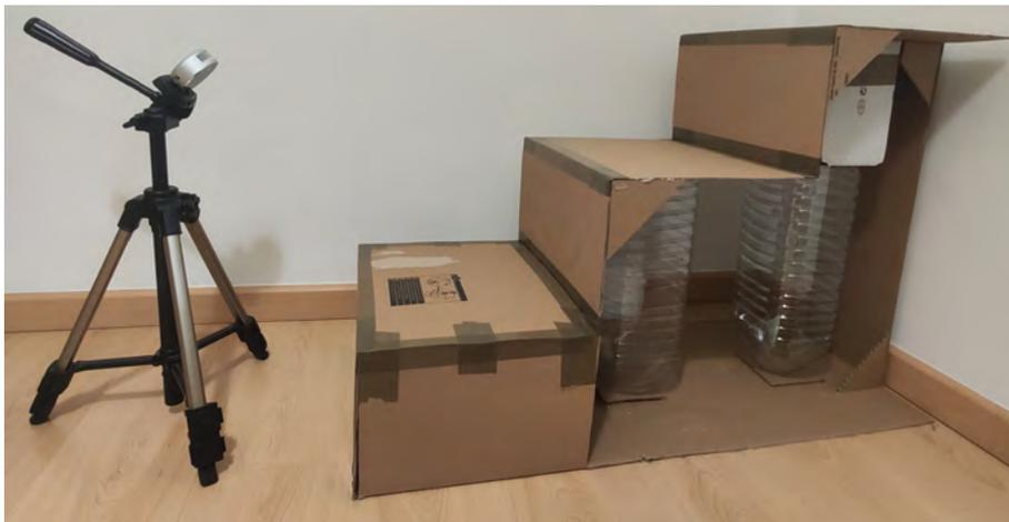
**Figura 6.1:** Entorno de pruebas con cámara de profundidad apuntando a los escalones.
