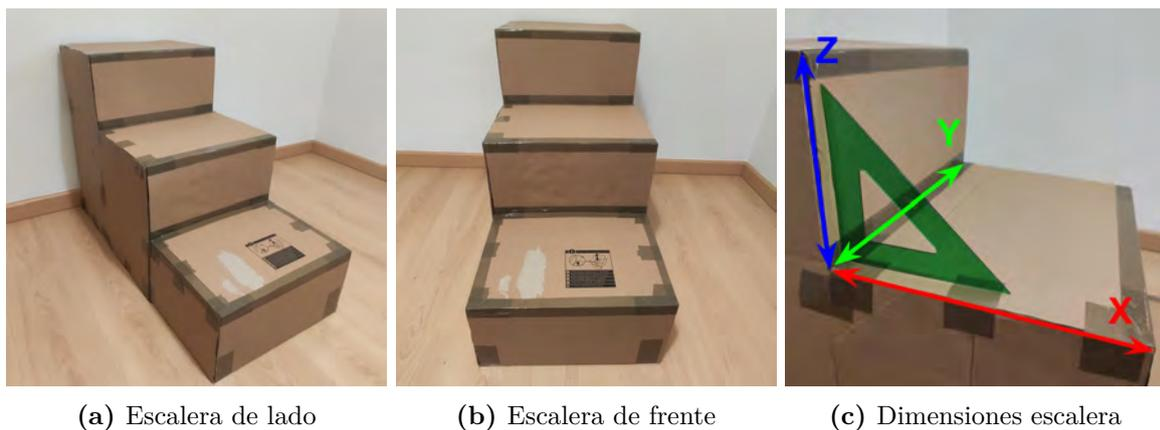
**Figura 5.2:** Imágenes de la escalera de cartón creada para realizar pruebas iniciales. En la Figura C, se puede ver una escuadra para confirmar que los escalones están a  $90^\circ$ . Las dimensiones de la escalera son X:30, Y:40 y Z:20 centímetros.
