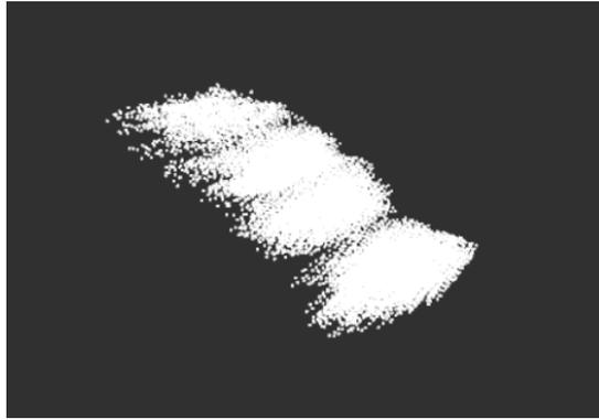
**Figura 3.12:** Visualización de los diferentes planos, provenientes de varios frames, una vez transformados al sistema de coordenadas global, Woo y cols. (2019)
