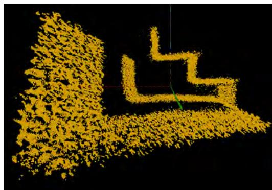
Figura 5.6: Nube de puntos trasladada y rotada
