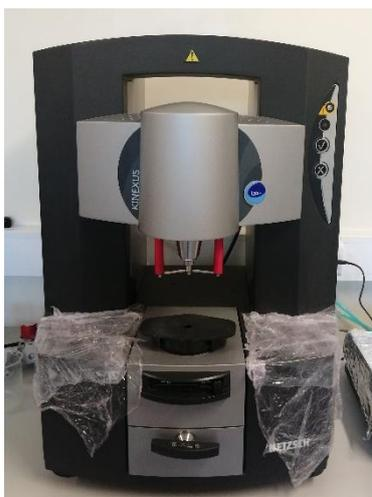
*Figura 12-Reômetro rotacional Kinexus Pro+.*
