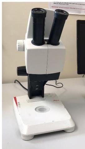
*Figura 19-Estereomicroscópio Leica EZ4 HD.*
