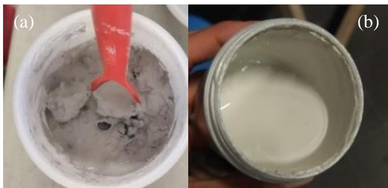
**Figura 25-**(a) Suspensão sem adição de CMC onde é visível o comportamento dilatante e (b) Suspensão com CMC.
