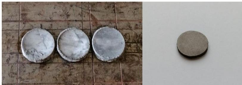
*Figura 30- Amostra antes de ser retificada (lado esquerdo), amostra depois de ser retificada (lado direito)*
