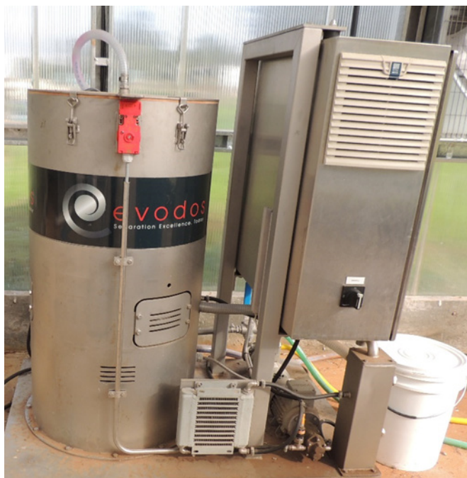
Figura 11. Centrífuga de fluxo contínuo para colheita e concentração (deságue) da biomassa de microalgas.
