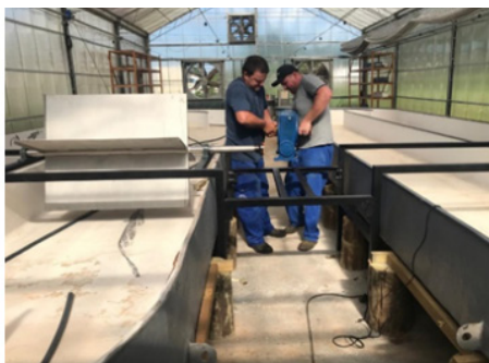
Figura 9. Instalação do eixo rotatório, pás e moto-reductor.
