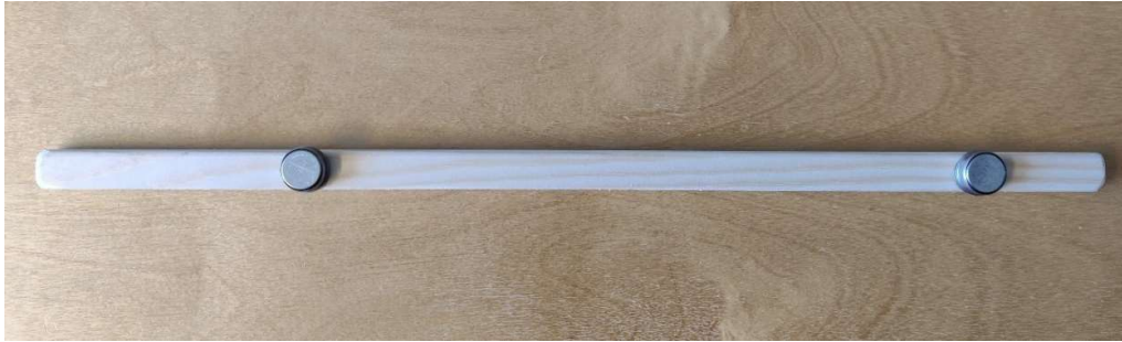
Kuva 5. Puutikkuun liimatut lämpötila-anturit (Thermochron iButton). Ennen maahan asentamista, tikku ja napit suojattiin vedeltä kolmikerroksisella polyeteenisukalla ja ilmastointiteipillä. Kuva: Liisa Jokelainen.
