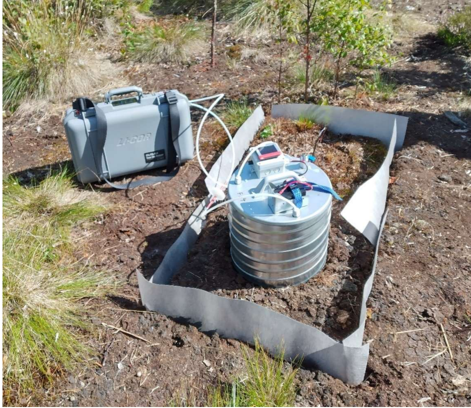
Kuva 4. Kammiomittalaitteisto (LI-COR ja kammio) Lautanevan koealalla. Kammio on asetettu kasvittomaan mittauspisteeseen mittaamaan heterotrofista hengitystä. Kasvihuonekaasut kulkevat kammion ja kasvihuonekaasuanalyysaattorin väliin kiinnitettyjen letkujen avulla. Kuva: Kari Laasasenaho.
