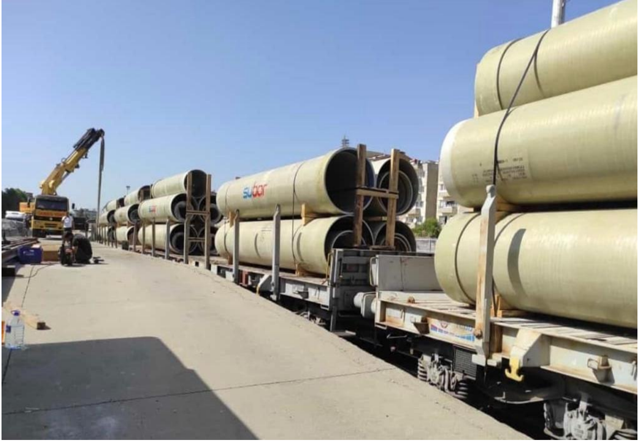
Şekil 2.1 Aydın Bozdoğan Ovası Sulaması Kapalı Borulu Sistem Sulaması CTP Boru Nakliyesi
