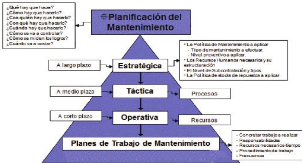
Figura 10. Planificación del mantenimiento
