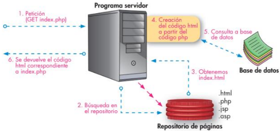
Figura 11. Esquema del funcionamiento del servicio web con paginas dinámicas
