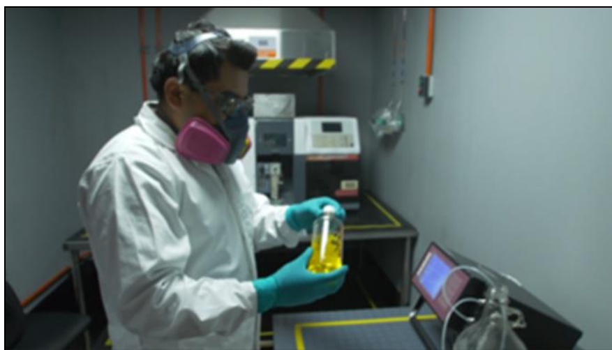
Figura 3.4. Prueba de conteo de partículas
