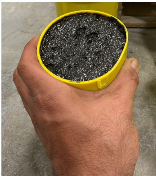
Unhardened UHPC at 6 hrs
