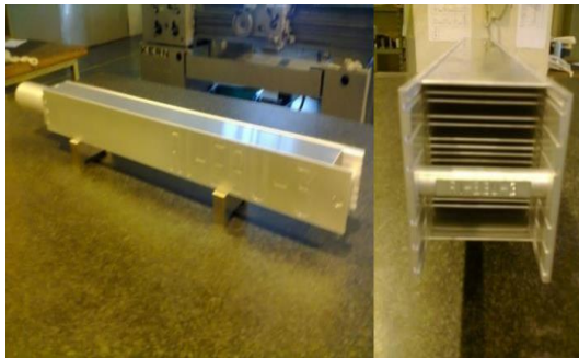
Gambar 1. Prototipe Elemen Bakar Uji U_3Si_2/Al densitas 4,8 \text{ gU/cm}^3 [1]
