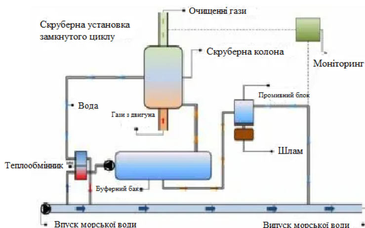
Рис. 1 Мокрий скрубер замкнутого циклу
