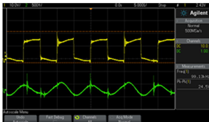
Рисунок 4.3. Форми сигналів вихідної напруги та струму LLC перетворювача лабораторної установки
