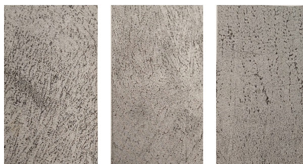
Рис. 4. Мікроструктура (X100) наплавленого металу в зоні перекриття валиків: а – стаціонарна дуга; б – модульований струм, частота 1,1 Гц; в – модульований струм, частота 0,5 Гц
