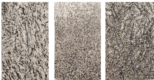
Рис. 3. Мікроструктура X200 наплавленого металу в зоні пошарового накладання валиків: а – стаціонарна дуга; б – модульований струм: б – частота 1,1 Гц; в – частота 0,5 Гц
