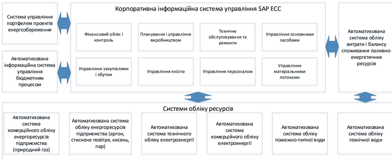
Рисунок 1 – Існуюча структурна схема комп’ютерної системи планування та управління портфелем проектів енергозбереження на ПрАТ «Дніпрспецсталь»
