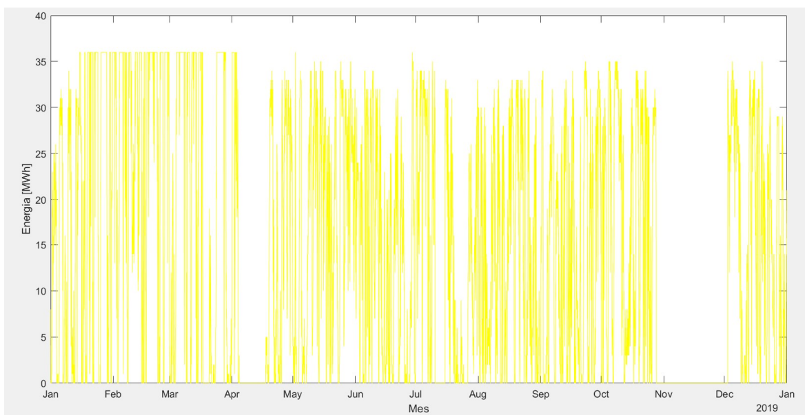
Figura 6.6. Energia generada pel parc eòlic West Wind en MWh, en intervals de 30 minuts, any 2019.
