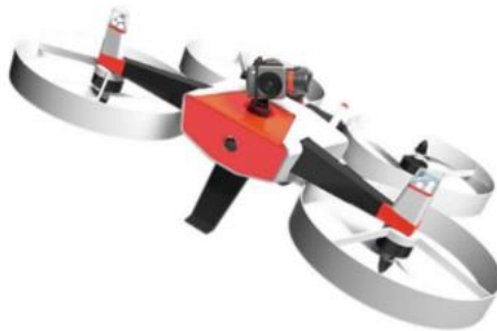
Figura 12. Dron creado por DNV-GL para inspecciones – Fuente: DNV-GL (ADRASSO).
