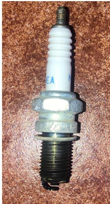
Figura 52 Bujía extraída y deteriorada. Fuente, Autores
