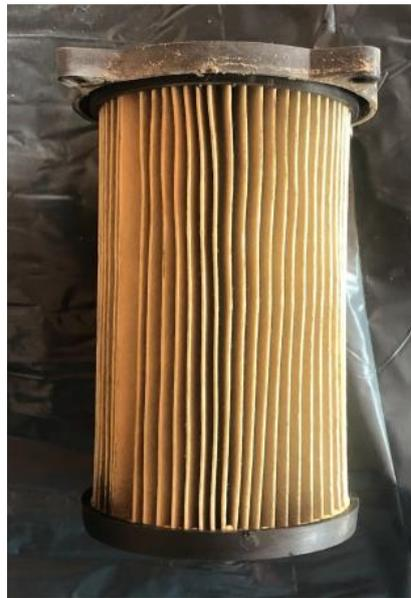
Figura 44 Filtro del aire extraído. Fuente, Autores
