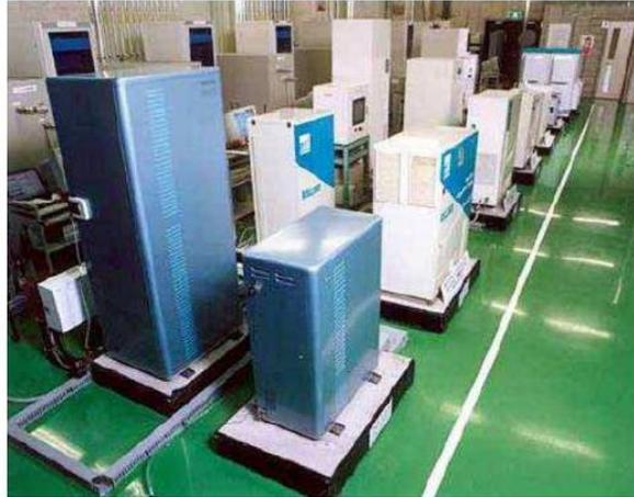
Figura 20 Pilas de hidrógeno estacionarias. Fuente,(39)
