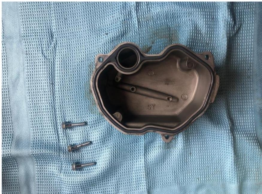
Figura 47 Tapa de balancines extraída. Fuente, Autores.
