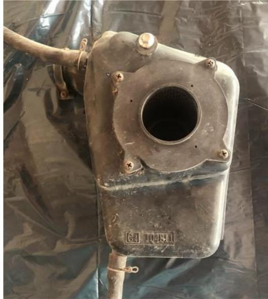
Figura 45 Caja del filtro del aire. Fuente, Autores
