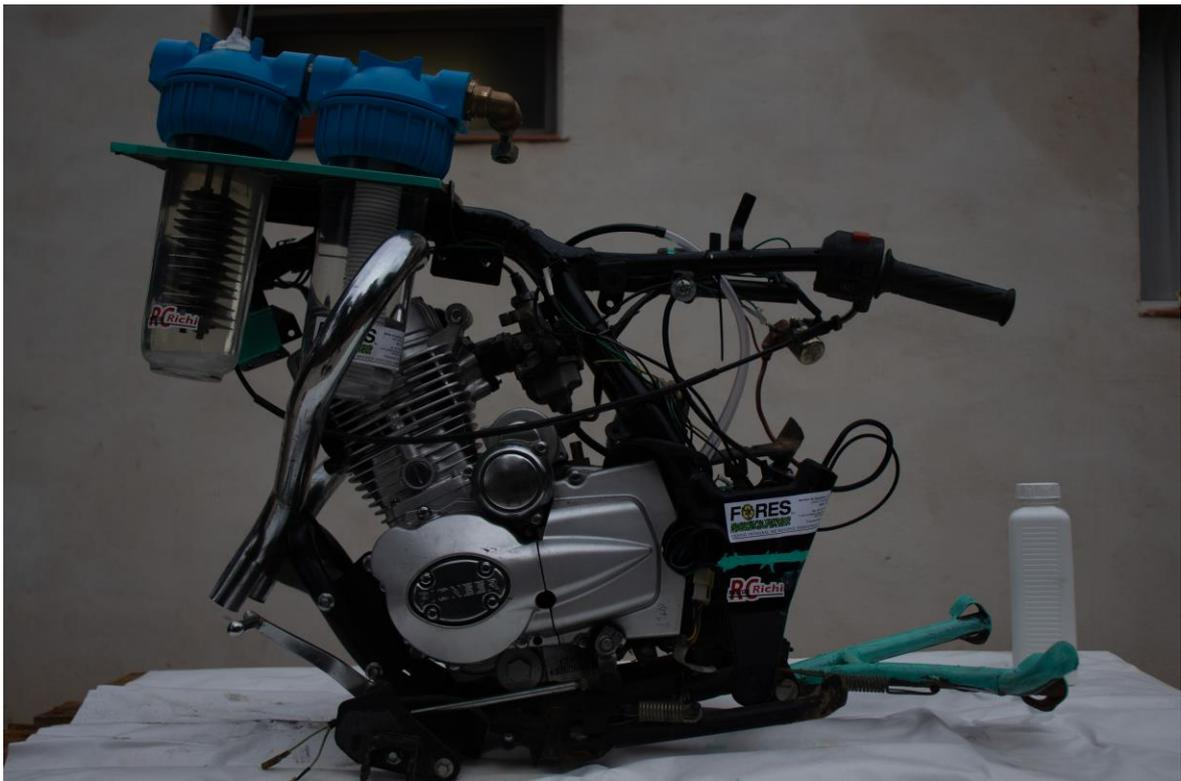
Figura 69 Motor y generador de hidrógeno montado. Fuente, Autores
