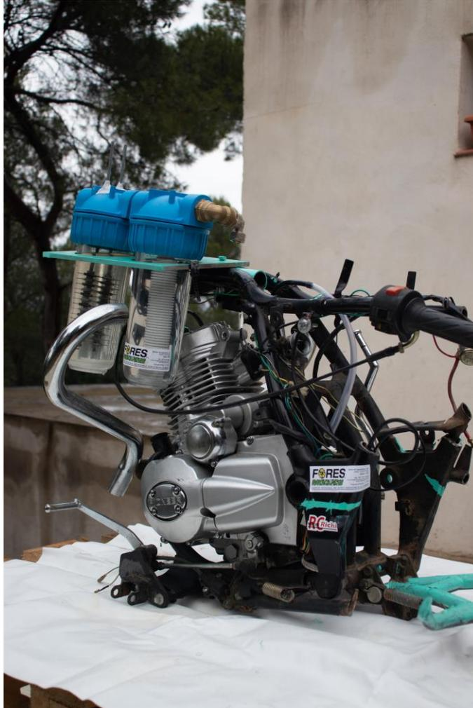
Figura 71 Motor y generador montado. Fuente, Autores
