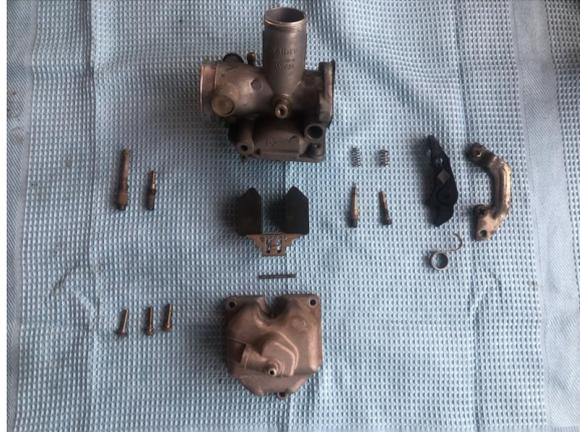
Figura 46 Carburador desmontado. Fuente, Autores
